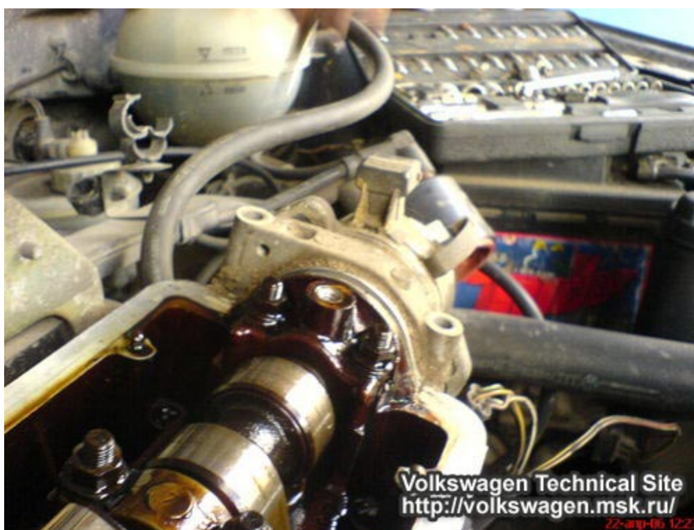
Снимаем трамблер (предварительно нацарапав или нарисовав риски его положения - чтобы потом не мучится с зажиганием)
