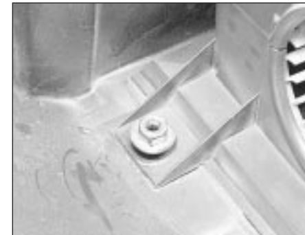
16.5a Heater fan motor retaining nut
